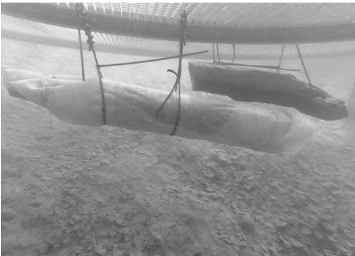
Deponovanie dreva pod vodou v experimentálnom depozitári
